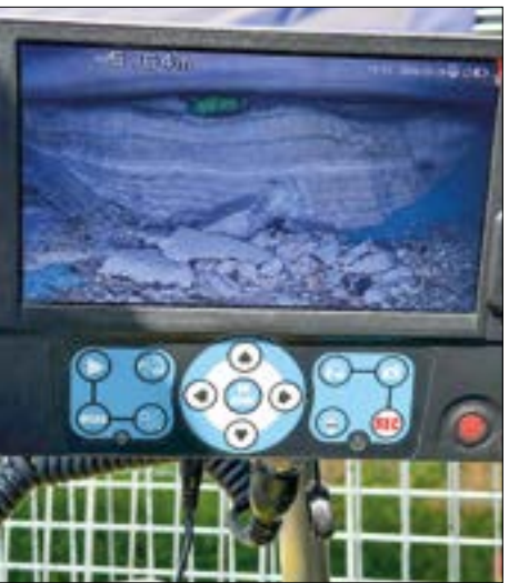
Die Fotos zeigen beispielhaft den Zustand von Abwasserleitungen, wenn der Unterhalt über längere Zeit vernachlässigt wird.
